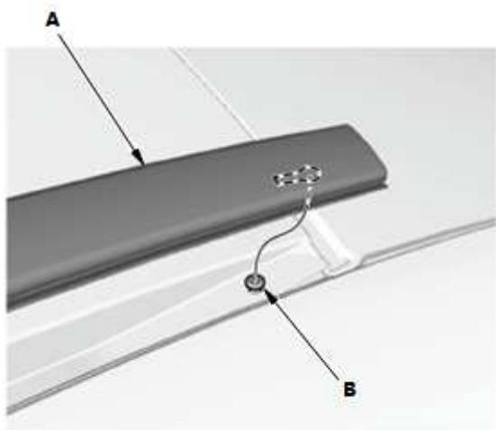
3. 将车顶装饰条 (A) 的车顶区域安装在夹持器 (B) 上。
