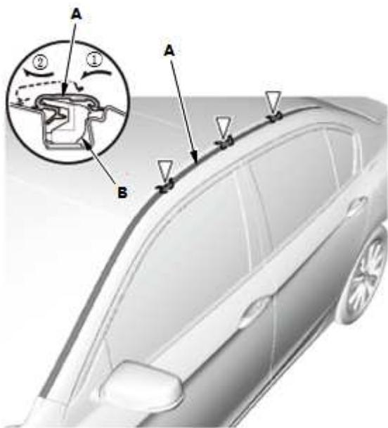
6. 将车顶装饰条 (A) 的后端从销 (B) 上拆下。
