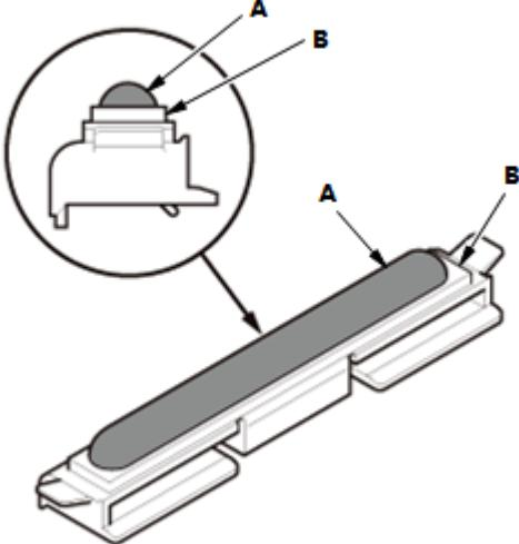
2. 使用经异丙醇浸湿的抹布清洗车身粘合表面。清洗后，避免机油、润滑脂和水溅到干净的表面。
