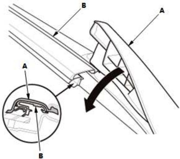
2. 将车顶装饰条 (A) 的后端安装在销 (B) 上。
